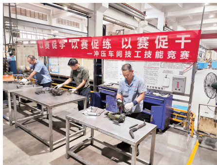
冲压车间手工修整凸模圆角
